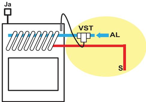
La valvola di scarico termico (VST - fornita da Edilkamin) deve essere collegata al circuito di raffreddamento (AL) con pressione minima 1,5 bar.
