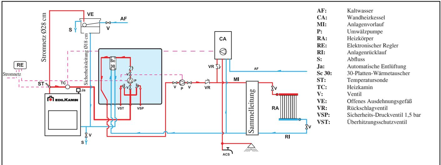
Der Bausatz Kit 2 wurde geschaffen, um die Aufgabe der Installateure zu erleichtern; er enthält nämlich alle für eine ordnungsgemäße Installation des Produkts erforderlichen Bestandteile.
