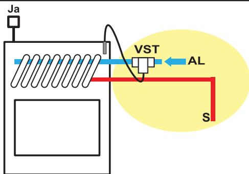
Das Überhitzungsschutzventil (ÜSV - von Edilkamin bereitgestellt) ist mit einem Mindestdruck von 1,5 bar an den Kühlkreislauf (AL) anzuschließen.
