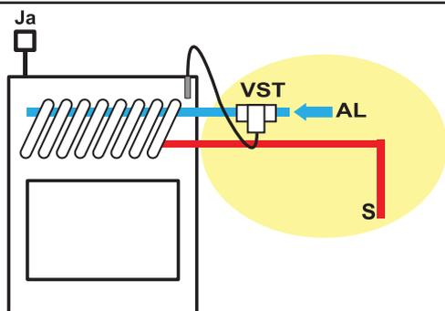
La válvula de descarga térmica (VST – suministrada por Edilkamin) debe ser conectada al circuito de enfriamiento (AL) con presión mínima 1,5 bar.
