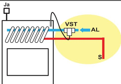
Izpustni ventil za toploto (VTI - del opreme Edilkamina) je potrebno priklopiti na hladilno napravo (AL) z najnižjim tlakom od 1,5 bar.
