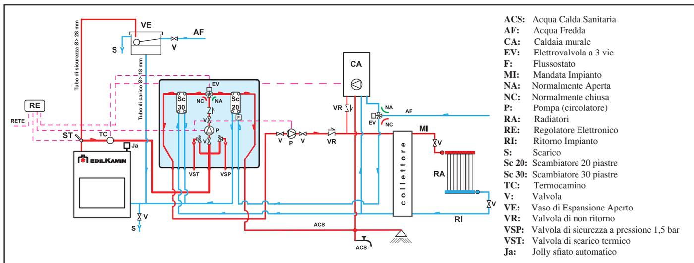
Il Kit 3 è stato realizzato per facilitare il compito degli installatori; comprende infatti tutti quei componenti necessari ad una corretta installazione del prodotto.
