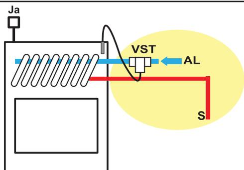
De thermische afvoerklep (VST - geleverd door Edilkamin) dient op het koelcircuit (AL) met een minimum druk van 1,5 bar te worden aangesloten.
