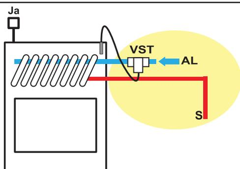
La soupape d'échappement thermique (VST - fournie par Edilkamin) doit être reliée au circuit de refroidissement (AL) avec une pression minimum de 1,5 bar.
