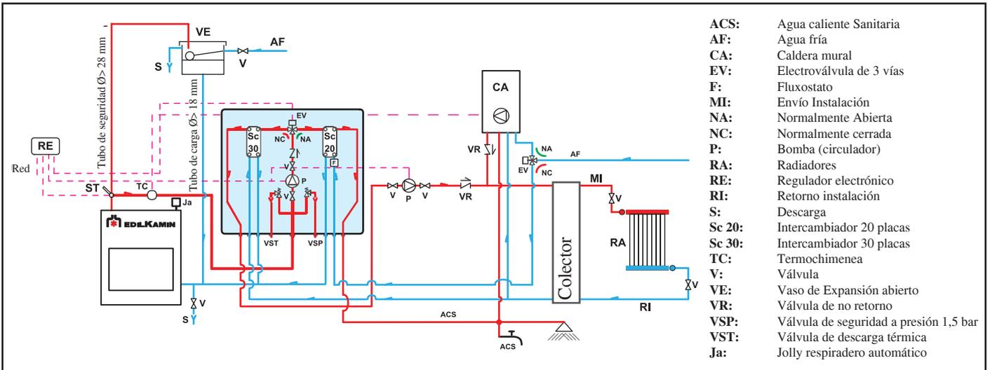
El kit 3 está realizado para facilitar la tarea de los instaladores, de hecho comprende todos los componentes necesarios para una correcta instalación del producto.
