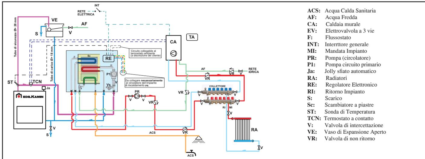
Il Kit N3 è stato realizzato per facilitare il compito degli installatori; comprende infatti tutti quei componenti necessari ad una corretta installazione del prodotto.
